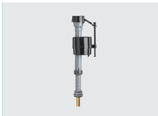
▲ Ventil za punjenje 400, priključak od mesinga G 3/8, niski spoj
